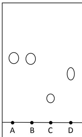
On a bien extrait l'éthanoate de butyle. Il est pur car le dépôt A ne révèle qu'une seule tache. Les manipulations ont été correctement effectuées et le résultat est celui attendu.
