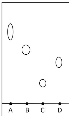
La tache du dépôt A ne correspond a aucun composé. Il y eu une erreur dans les réactifs utilisés. Il faut recommencer la transformation.
