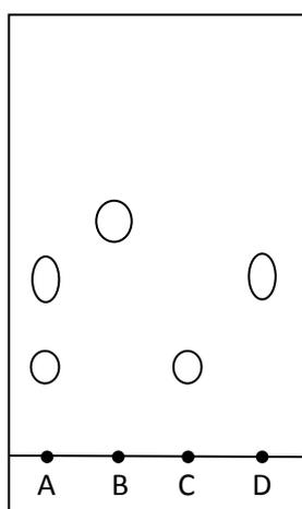
Le mélange extrait est composé d'acide éthanoïque et de butan-1-ol.. On s'est trompé de phase lors de l'extraction car l'acide éthanoïque est dans la phase aqueuse et l'éthanoate de butyle dans la phase organique.
