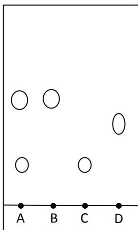
On a bien extrait l'éthanoate de butyle (taches identiques pour les dépôts A et B ), mais il reste après extraction de l'acide éthanoïque ( autre tache du dépôt A ). L'extraction a été mal faite, il faut la recommencer.
