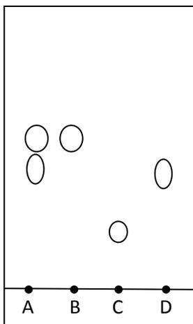
On a bien extrait l'éthanoate de butyle ( tache identiques pour les dépôts A et B ), mais il reste après extraction du butan-1-ol ( autre tache du dépôt A ). L'extraction a été mal faite, il faut la recommencer.
